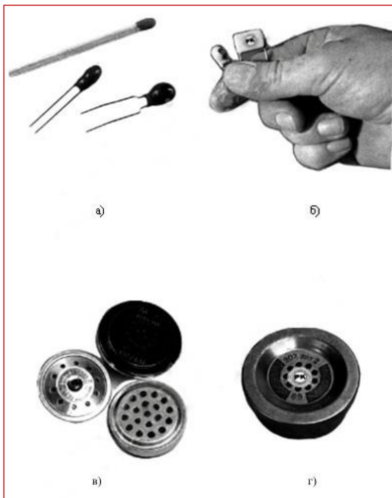
Рисунок 1.3 – Примеры исполнения телефонных закладок а,б) телефонные закладки, выполненные в виде конденсаторов; в,г) телефонные закладки в виде капсулей.
