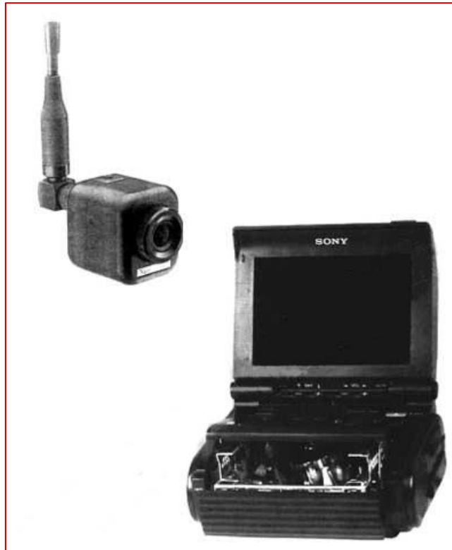
Рисунок 1.6 – Портативный телевизионный передатчик, конструктивно объединенный с телевизионной камерой и портативное записывающее устройство
